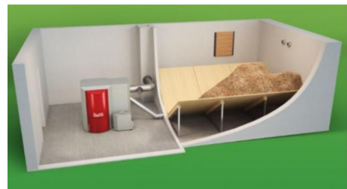
Local dédié avec pan incliné et alimentation par vis sans fin
