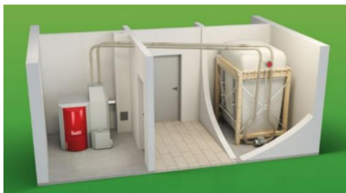
Silo textile et alimentation par aspiration
