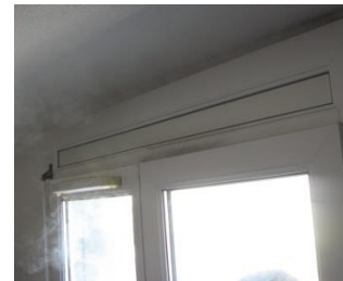
Détection des fuites à l'aide de fumigènes
