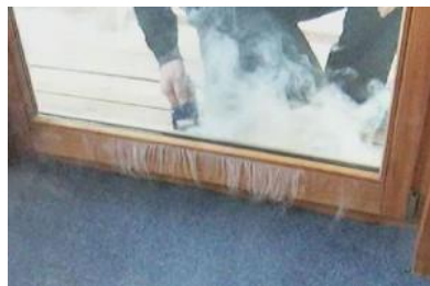
Détection des fuites à l'aide de fumigènes
